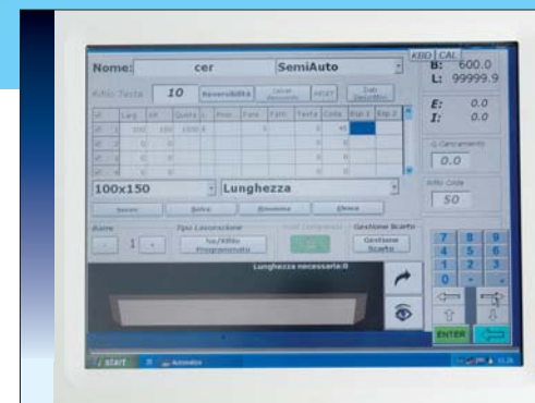
PC industriale in ambiente Windows Industrial PC with Windows operating system Ordinateur industriel avec logiciel Windows PC industrial con sistema operativo Windows
