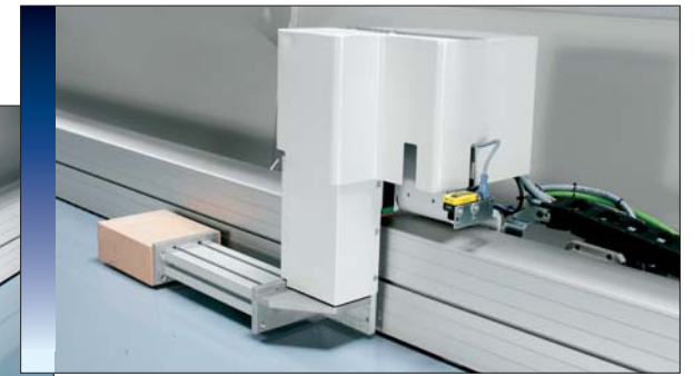
Dettaglio dello spintore con sensore di misurazione pezzo Detail of the pusher with measuring sensor Detail du pousseur avec capteur de mesuration de la piece Detalle del empujador con sensor de medicion pieza
